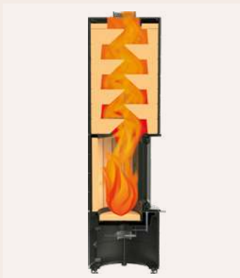
COLONA: Lenkung der Heizgase durch Schamottekern Control of the hot gases through chamotte core
